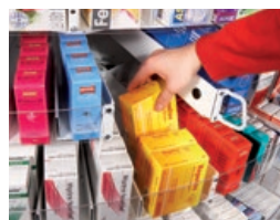
Respect du principe « first in, first out » : remplissage des canaux inclinés par l'arrière
