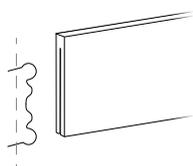
En standard, nos tiroirs à cathéters sont fournis avec un plateau à séparations. Les cloisons de séparation sont fixées au moyen d'un système de montage éprouvé. Un système de ressort est monté dans le plateau à séparations, ses cloisons comportent une encoche fraisée dans laquelle le ressort s'adapte avec précision. De cette façon, la cloison est bien fixée au plateau. Sur demande, un plateau totalement lisse et sans séparations peut également être réalisé.
